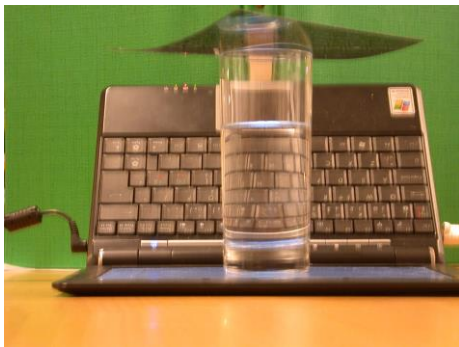
Fig 1: Glukoslösning i ett dricksglas på en liten laptop och polaroidfilter från sidan
