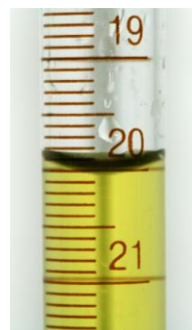
Bild 4 Volymen mäts i lägsta punkten (20,0 ml.)
